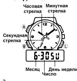
На рис.1., изображен общий вид часов в режиме Текущего времени. Кнопка В осуществляет переход между режимами часов. Переход между режимами осуществляется в следующей последовательности:
