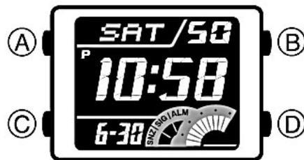
На рисунке изображен общий вид часов в Режиме Текущего Времени. Последовательное нажатие кнопки “С” обеспечивает переход из разряда в разряд в следующей последовательности: Режим Текущего Времени – Режим Мирового Времени – Режим Секундомера – Режим Таймера Обратного Отсчета – Режим Звукового Сигнала – Режим Текущего Времени.
