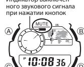
Индикатор выключенного звукового сигнала при нажатии кнопок
